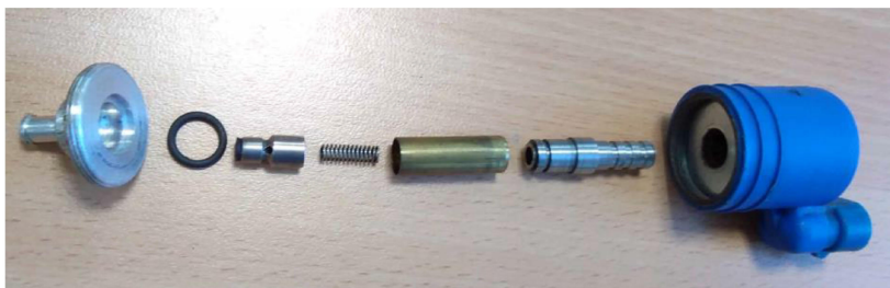
Rys. 5.34. Budowa wewnętrzna tłoczkowego wtryskiwacza LPG.
