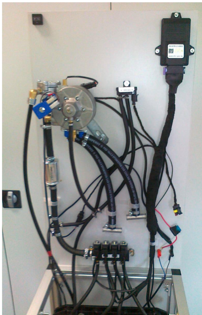
Rys. 5.30. Rozmieszczenie wszystkich komponentów front-kitu.
