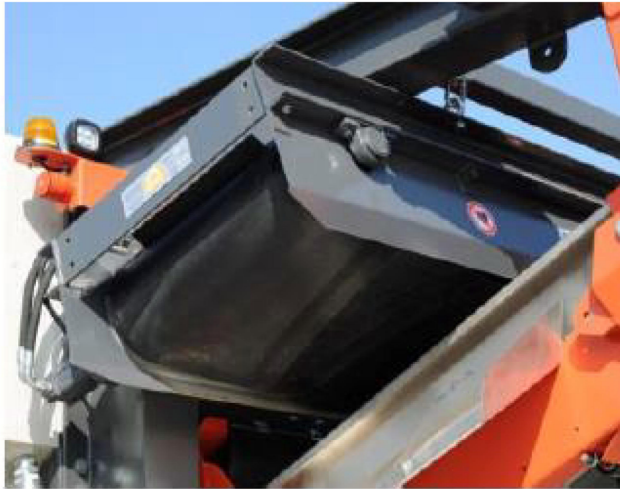
Rys. 3.14. Separator magnetyczny w kruszarce [76].
