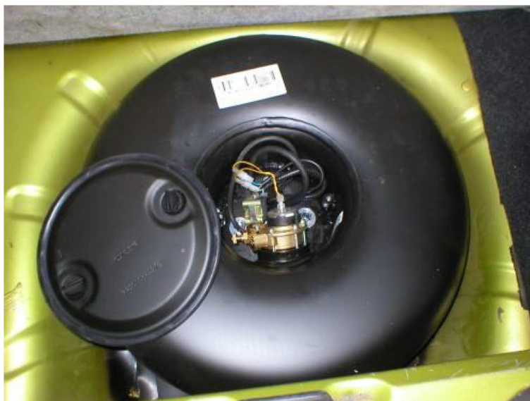
Rys. 5.14. Zbiornik gazu LPG.
