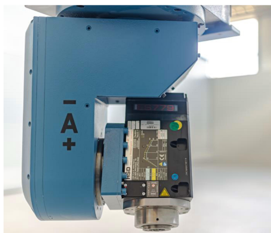
Rys. 2.6. Elektrowrzeciono do maszyny CNC zamocowane na obrabiarce [60].
