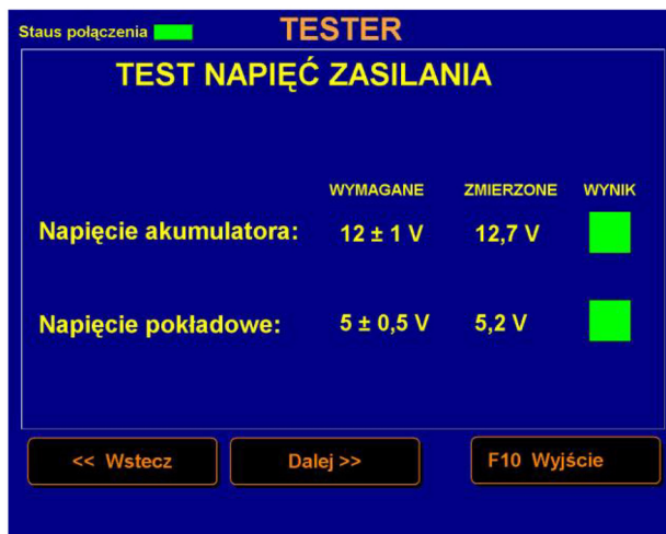
Rys. 5.8. Okno testu napięć zasilania.
