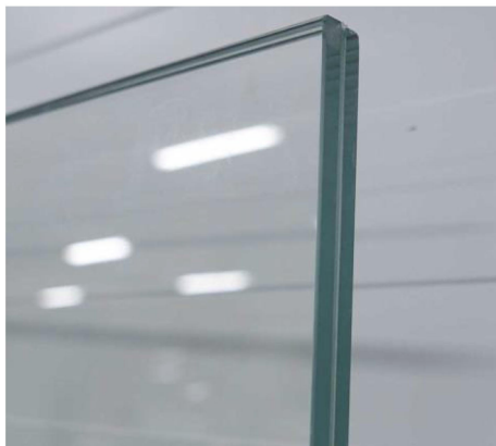
Rys. 4.9. Ocena jakości wypływkki szkła laminowanego.
