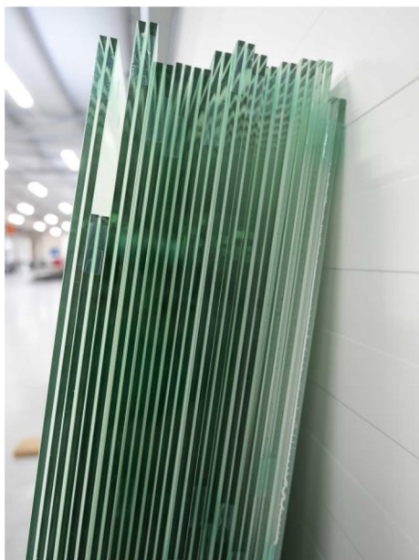
Rys. 4.8. Produkty w postaci szkła laminowanego na wyjściu z linii technologicznej.
