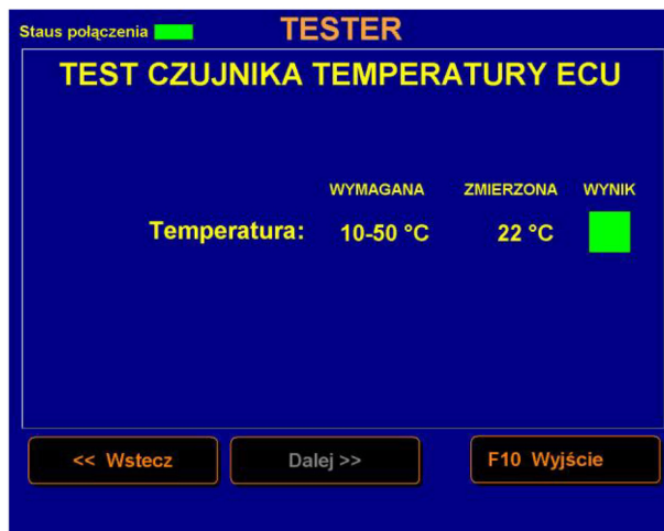
Rys. 5.7. Okno testu czujnika temperatury ECU.
