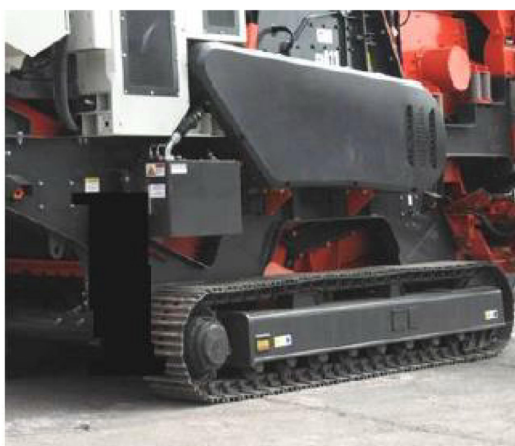
Rys. 3.10. Gąsienicowy układ jezdny kruszarki [76].
