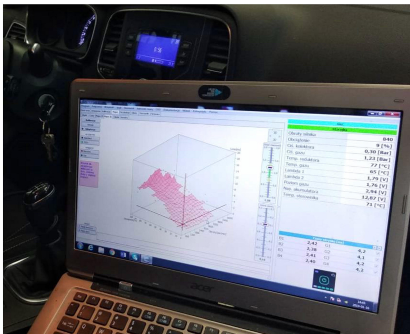
Rys. 5.40. Okno kalibracji 3D podczas jazdy.
