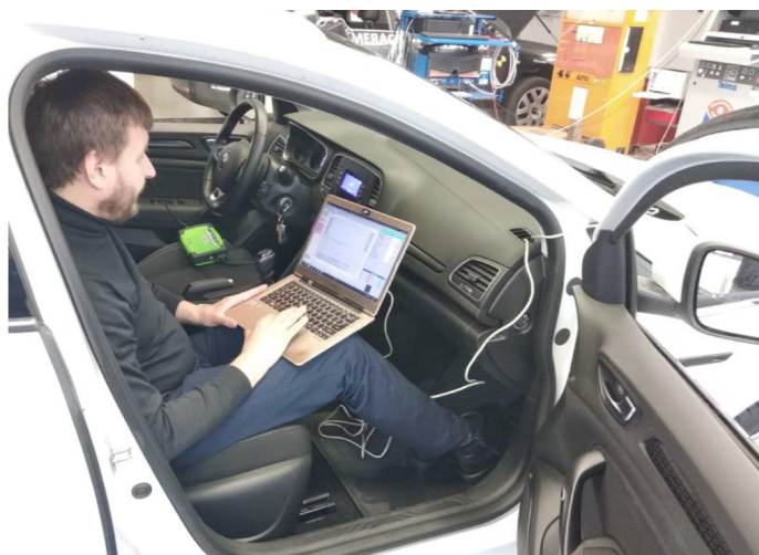
Rys. 5.36. Podłączenie komputera przenośnego z systemem sekwencyjnego wtrysku gazu.
