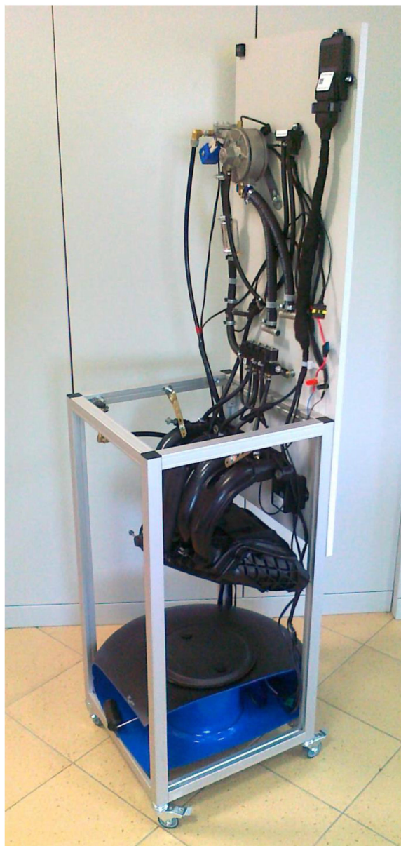
Rys. 5.31. Widok finalnego stanowiska badawczego systemów gazowych.
