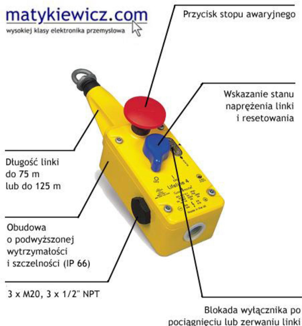
Rys. 3.22. Wyłącznik linkowy – opis przycisków [78].
