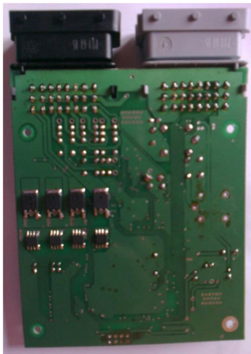
Rys. 5.4. Płytką drukowaną elektronicznej jednostki sterującej wtryskiem LPG – dół.
