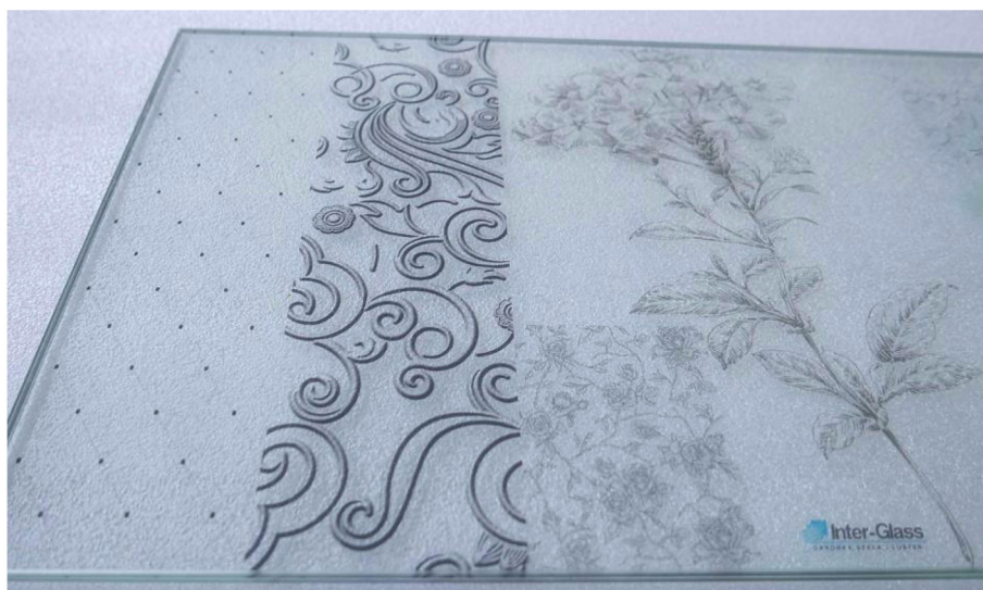
Rys. 4.10. Ocena cech wizualnych szkła laminowanego na wyjściu z linii technologicznej.
