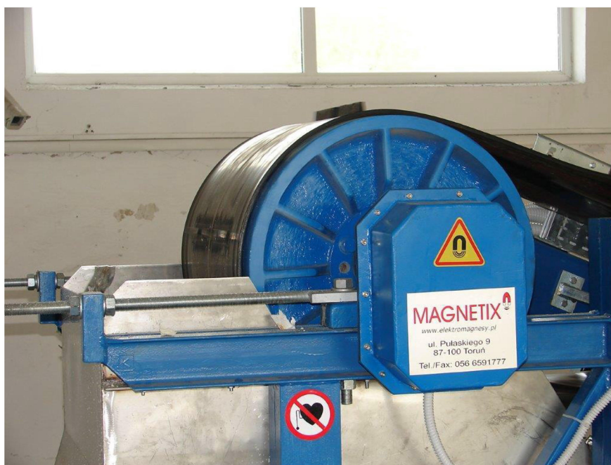
Rys. 3.19. Bęben magnetyczny w zastosowaniu stacjonarnym.
