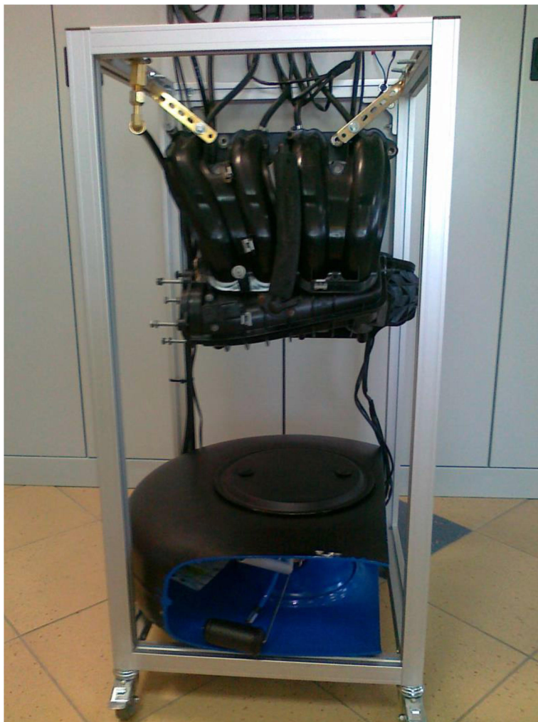
Rys. 5.25. Montaż zbiornika i kolektora dolotowego na wózku jezdnym.
