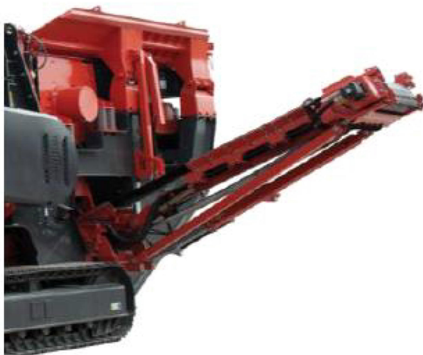
Rys. 3.12. Przenośnik boczny drobnego ziarna w kruszarce [76].
