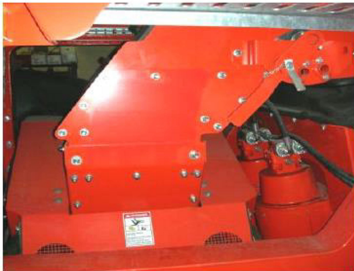
Rys. 3.6. Regulowany by-pass kruszarki [76].
