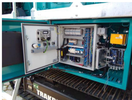
Rys. 3.5. Panel sterujący kruszarki – wygląd wnętrza
