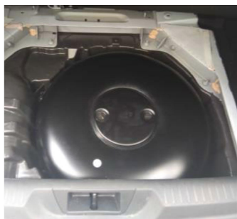
Rys. 5.3. Montaż zbiornika LPG.
