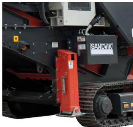
Rys. 3.11. Podpory stabilizujące kruszarki [76].
