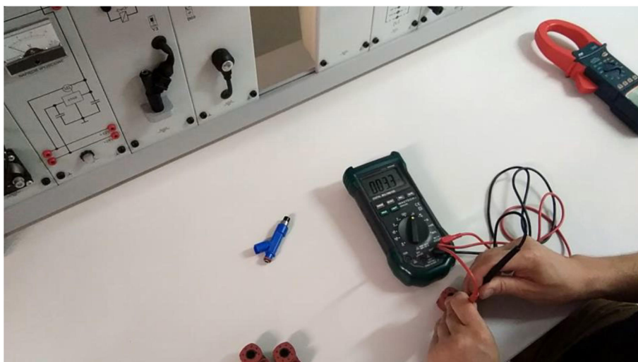
Rys. 5.35. Pomiar rezystancji uzwojeń wtryskiwaczy LPG.
