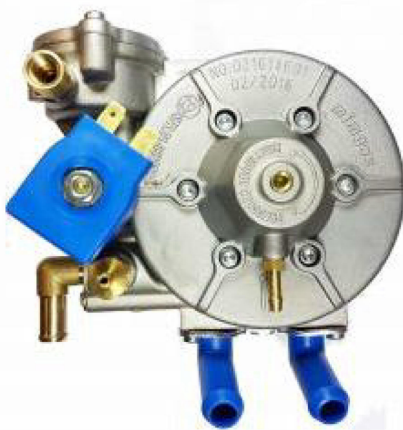
Rys. 5.19. Reduktor/parownik LPG z elektrozaworem odcinającym [72].
