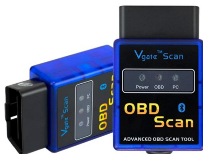
Rys. 5.10. Interface OBD komunikujący się za pomocą Bluetooth.
