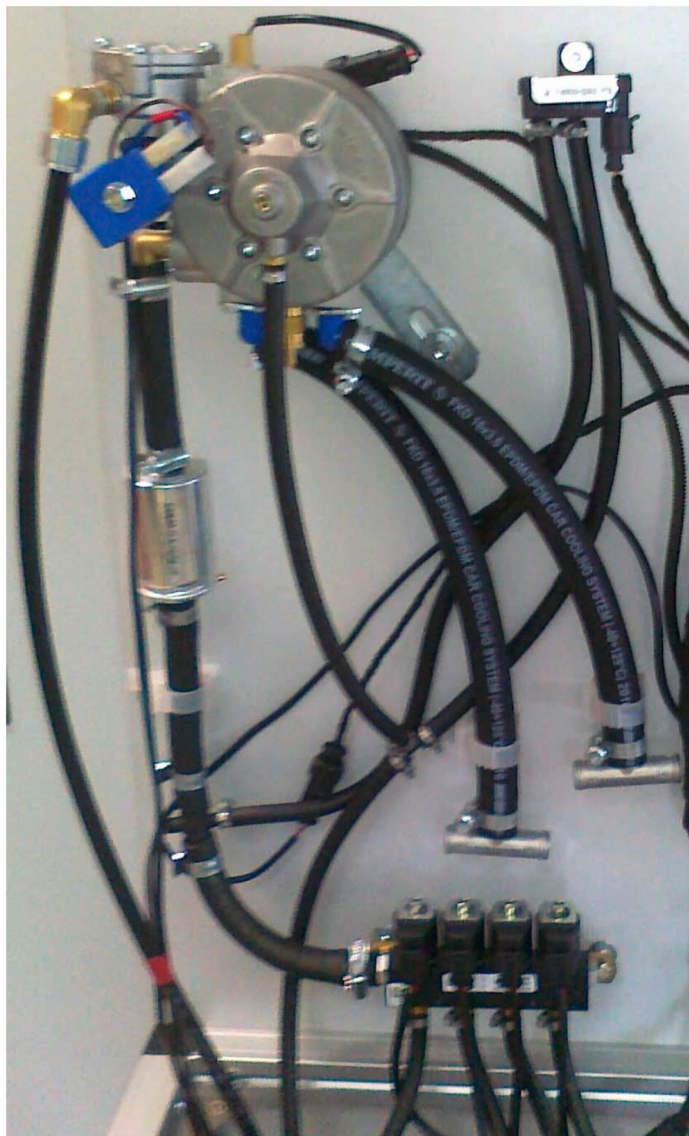
Rys. 5.28. Rozmieszczenie filtra LPG i wtryskiwaczy.
