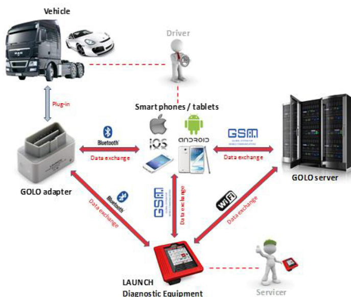
Rys. 1.37. Diagnostyka zdalna pojazdów z wykorzystaniem interfejsu Golo [46]
