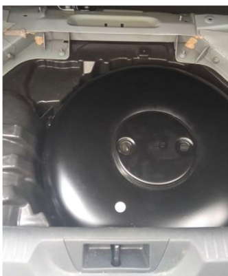
Rys. 4.3. Montaż zbiornika LPG
