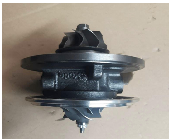
Rys. 3.31. Nowy rdzeń turbosprężarki
