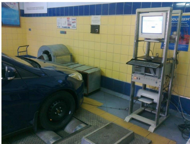
Rys. 2.7. Obiekt badań znajdujący się na hamownianym stanowisku badawczym
