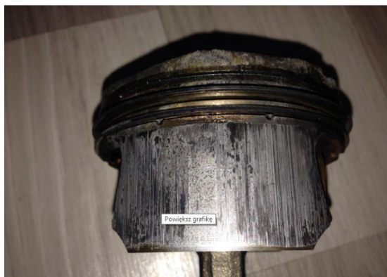
Rys. 3.17. Widok uszkodzonego tłoka
