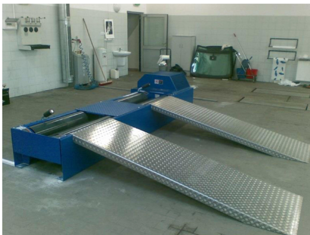
Rys. 2.1. Hamownia najazdowa jednoosiowa firmy Maha
