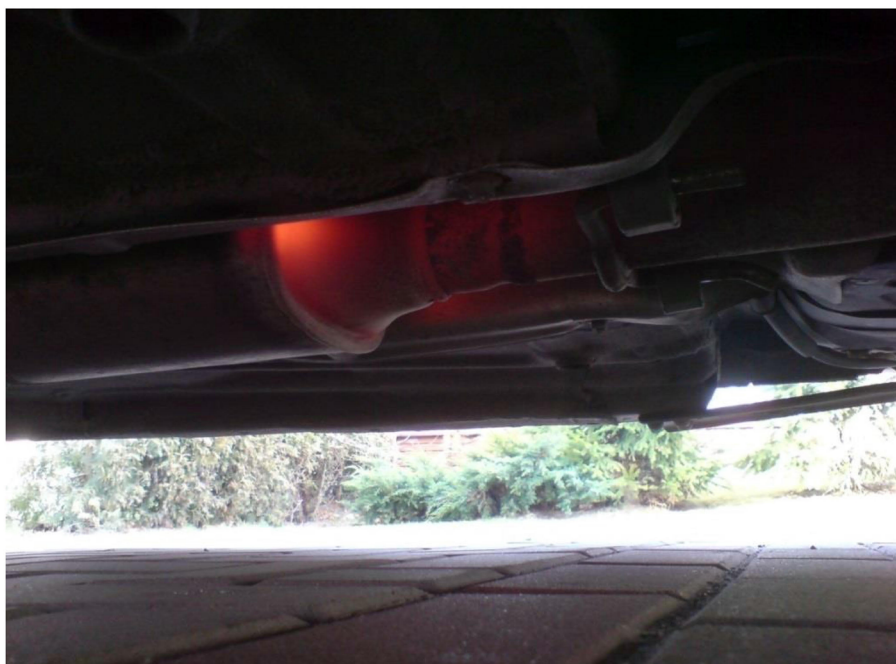
Rys. 2.16. Filtr podczas regeneracji serwisowej
