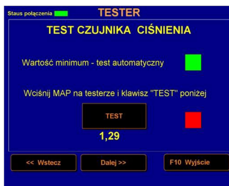
Rys. 4.4. Okno testu obwodu czujnika ciśnienia
