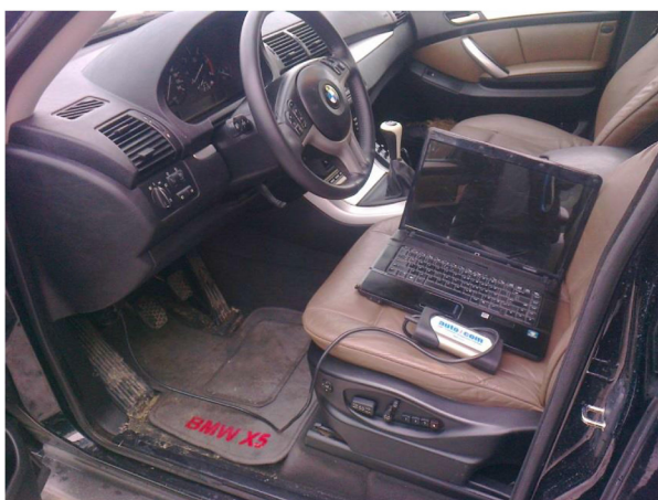
Rys. 3.40. Podłączenie urządzenia diagnostycznego
