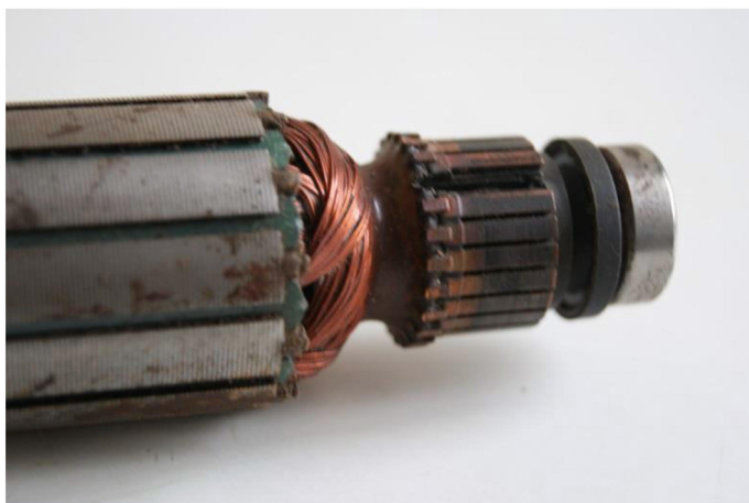
Rys. 5.17. Przykład uszkodzonego komutatora [33]
