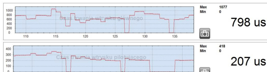
Rys. 3.46. Czas wtrysku głównego i pilotującego
