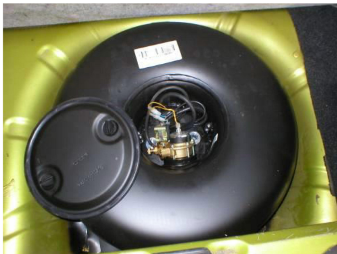
Rys. 4.10. Zbiornik gazu LPG
