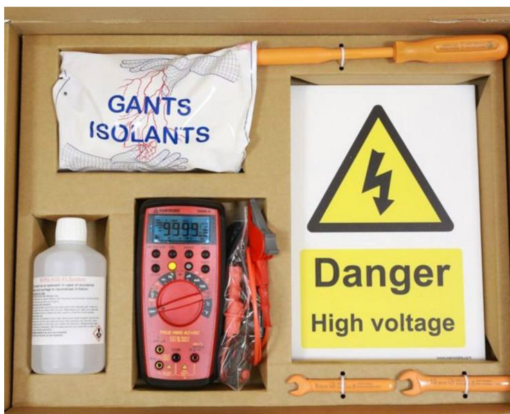
Rys. 5.2. Przykład kitu wyposażenia warsztatu serwisującego EV [44]
