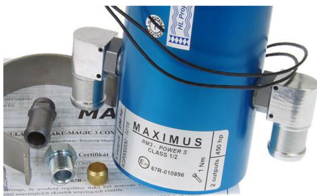
Rys. 4.15. Przykład oznakowania homologacyjnego umieszczonego na elementach instalacji gazowej [42]
