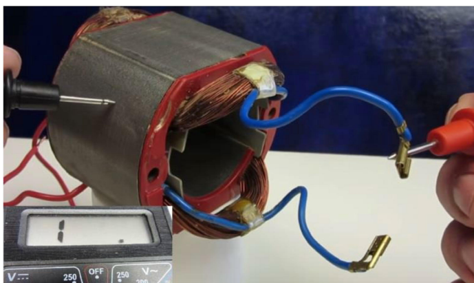
Rys. 5.19. Pomiar uszkodzenia wirnika za pomocą miernika uniwersalnego [35]
