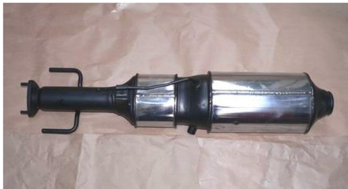
Rys. 2.4. Filtr DPF połączony bezpośrednio z katalizatorem [12]
