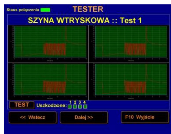
Rys. 4.7. Okno testu sygnałów otwierających wszystkie wtryskiwacze
