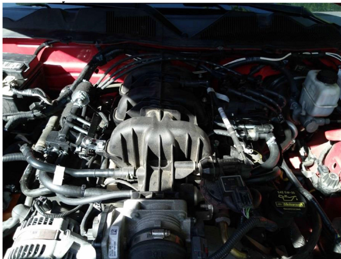
Rys. 4.14. Miejsce montażu wtryskiwaczy w pojeździe
