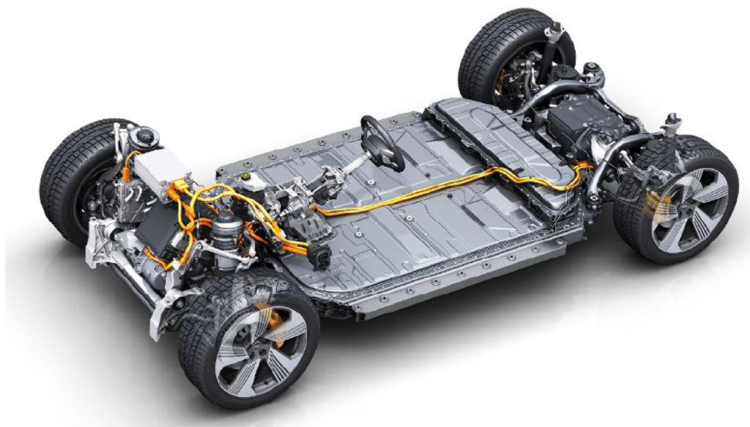
Rys. 4.1. Rozmieszczenie komponentów elektrycznego układu napędowego w Audi e-tron [55]
