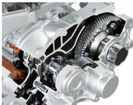
Rys. 2.14. Nissan Leaf II – silnik elektryczny z reduktorem [33]
