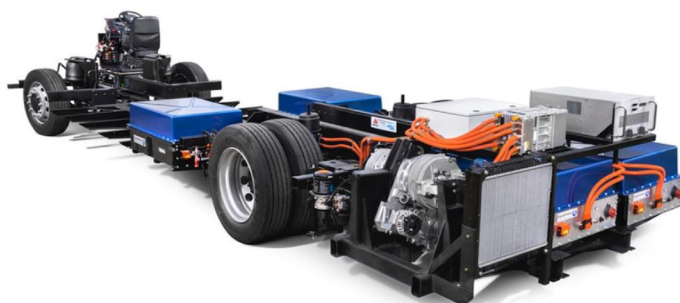
Rys. 2.22. Miejsce montażu pakietu baterii w ramie autobusu [116]
