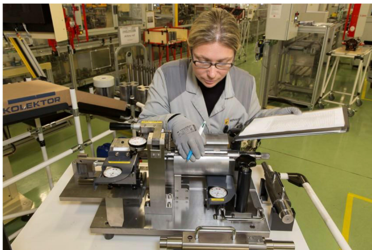
Rys. 1.18. Kontrola jakości wykonania złożenia wirnika silnika elektrycznego [21]
