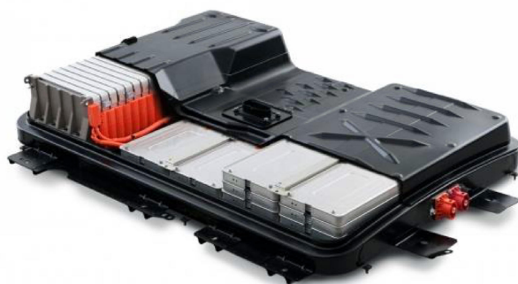
Rys. 2.19. Nissan Leaf II – pakiet baterii trakcyjnej [33]
