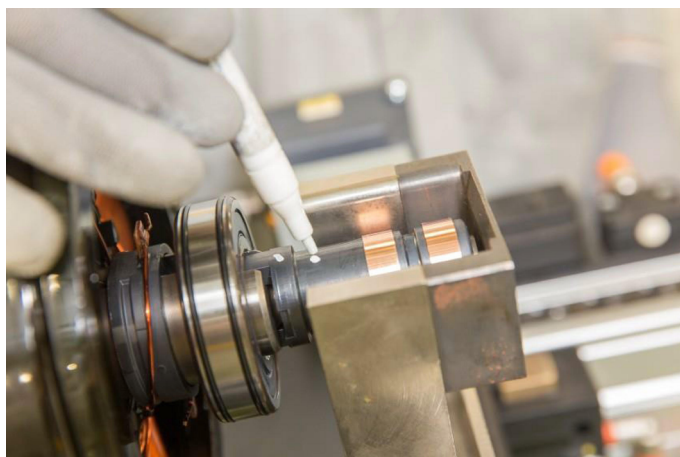
Rys. 1.13. Pierścienie ślizgowe na wirniku silnika elektrycznego [21]
