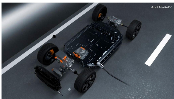
Rys. 2.15. Miejsce montażu pakietu baterii w Audi e-tron [112]
