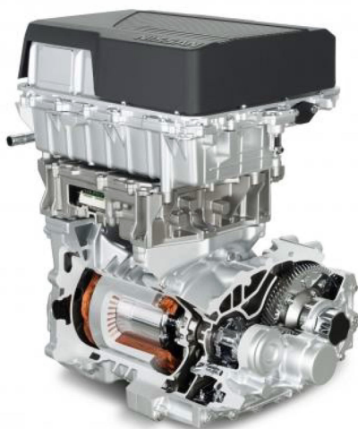
Rys. 2.12. Nissan Leaf II – silnik elektryczny z reduktorem i falownikiem [33]
