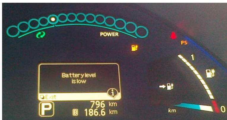
Rys. 2.27. Niski stan naładowania baterii na tablicy wskaźników
