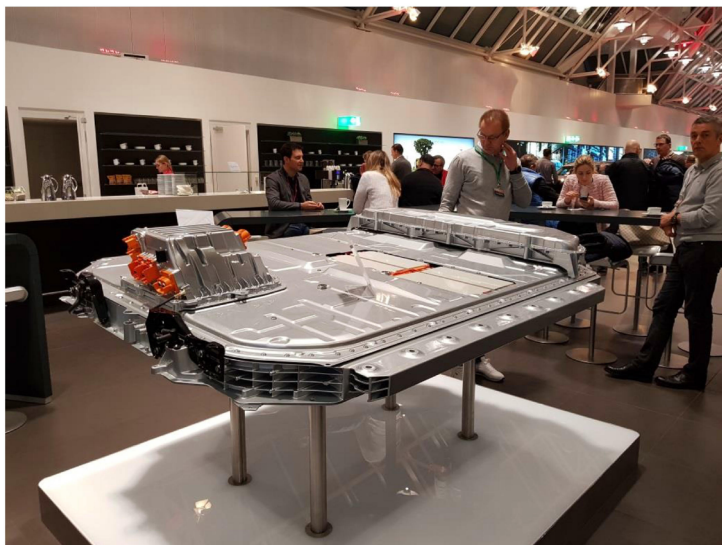
Rys. 4.10. Ekspozycja pakietu bateryjnego w Audi e-tron – przekroje w rzeczywistym obiekcie
