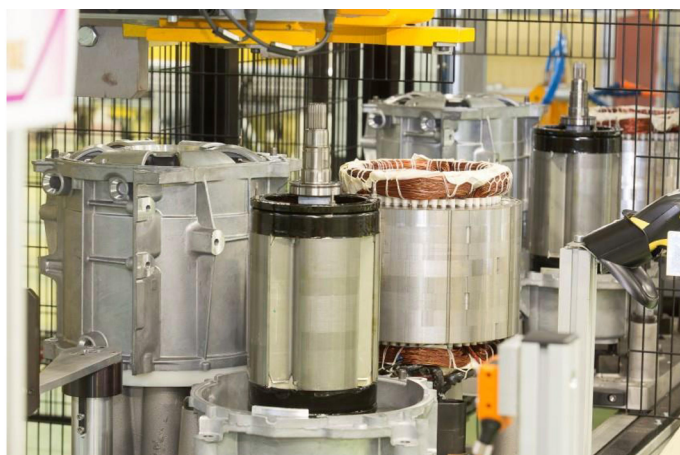
Rys. 1.14. Komponenty silnika elektrycznego (od lewej: obudowa, wirnik, stojan) [21]
