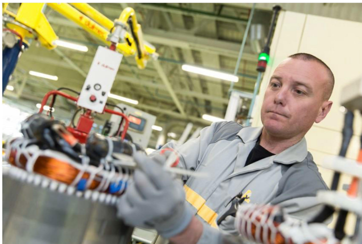
Rys. 1.19. Kontrola ciągłości uzwojeń w stojanie silnika elektrycznego [21]
