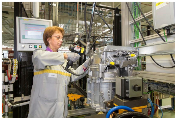
Rys. 1.21. Kompletne złożenie silnika elektrycznego z falownikiem [21]
