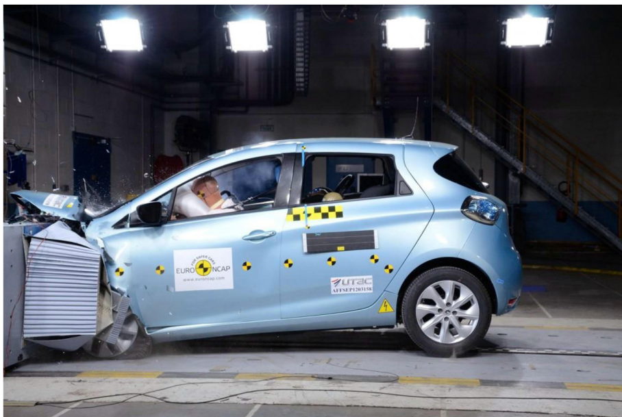
Rys. 1.7. Test zderzeniowy Renault Zoe [24]
