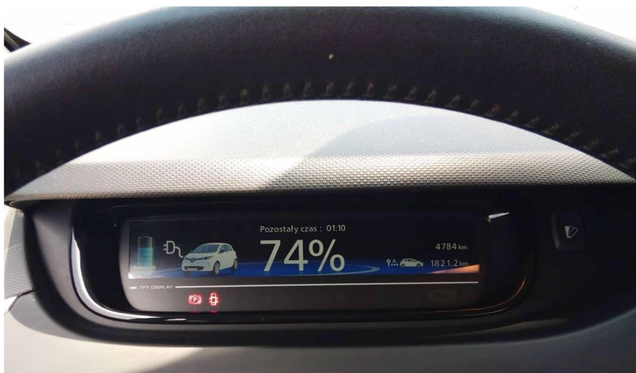
Rys. 1.52. Wskaźnik ładowania Renault Zoe na tablicy wskaźników
