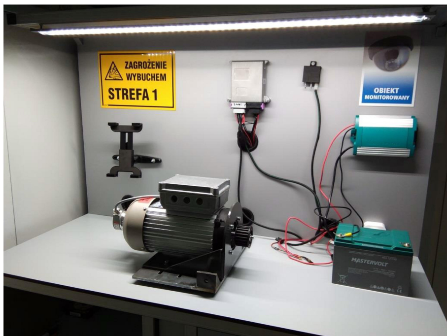
Rys. 1.23. Silnik PMSM 4 kW firmy ABM – badania laboratoryjne
