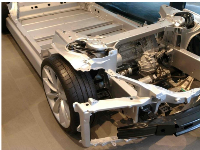
Rys. 1.15. Silnik i zawieszenie przednie Tesli model X - wygląd rzeczywisty
