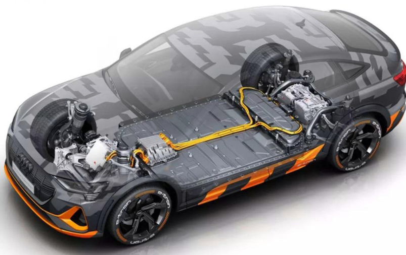
Rys. 4.7. Rozmieszczenie komponentów elektrycznego układu napędowego w Audi e-tron Sportback S / e-tron S [17]
