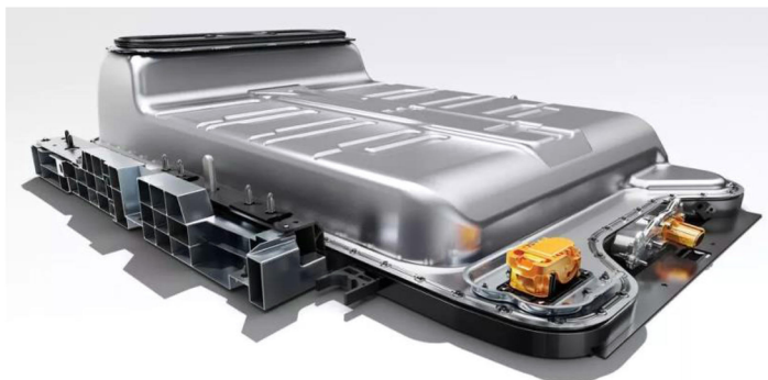
Rys. 1.28. Pakiet baterii o pojemności energetycznej 52 kWh w Renault Zoe [26]
