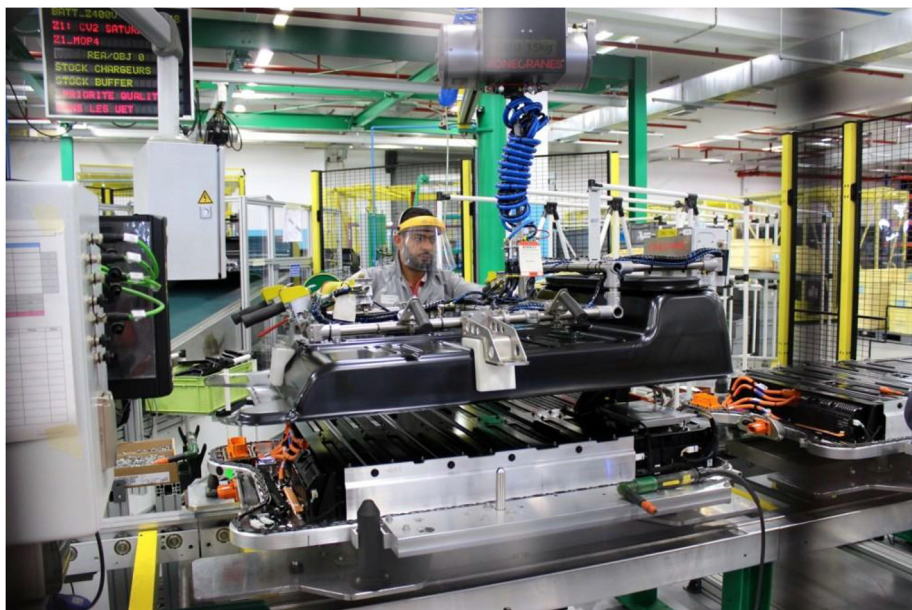
Rys. 1.39. Zamykanie pakietu baterijnego Renault Zoe [27]
