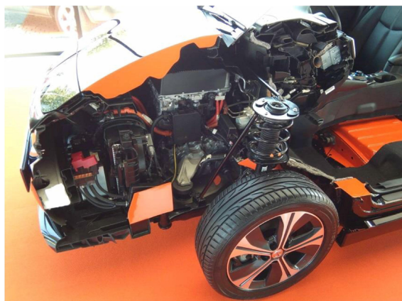
Rys. 2.11. Nissan Leaf II – umieszczenie silnika elektrycznego
