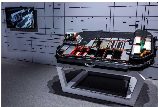
Rys. 2.12.6 Wygląd pakietu baterii w Audi e-tron [111]
