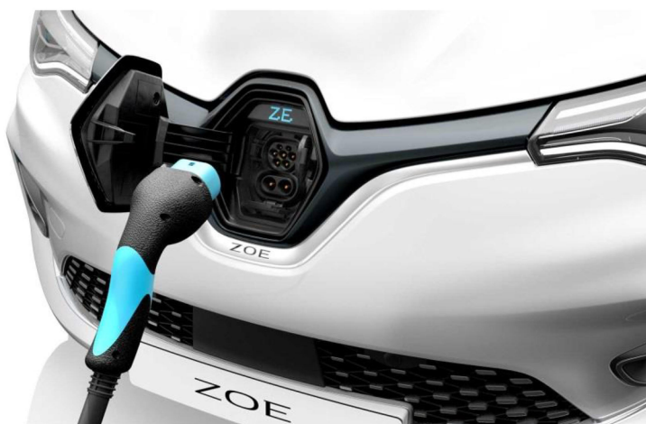
Rys. 1.46. Gniazdo CCS w Renault Zoe [28]
