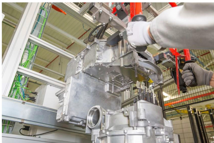
Rys. 1.20. Montaż falownika na silniku elektrycznym [21]
