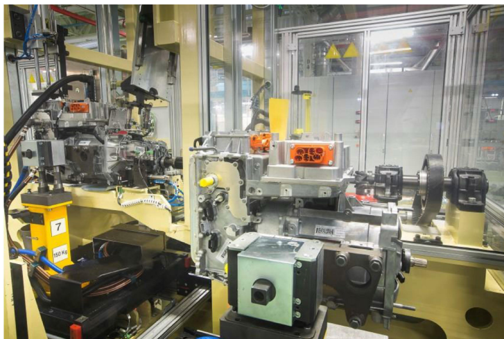
Rys. 1.24. Testowanie kompletnego silnika elektrycznego na hamowni silnikowej [21]
