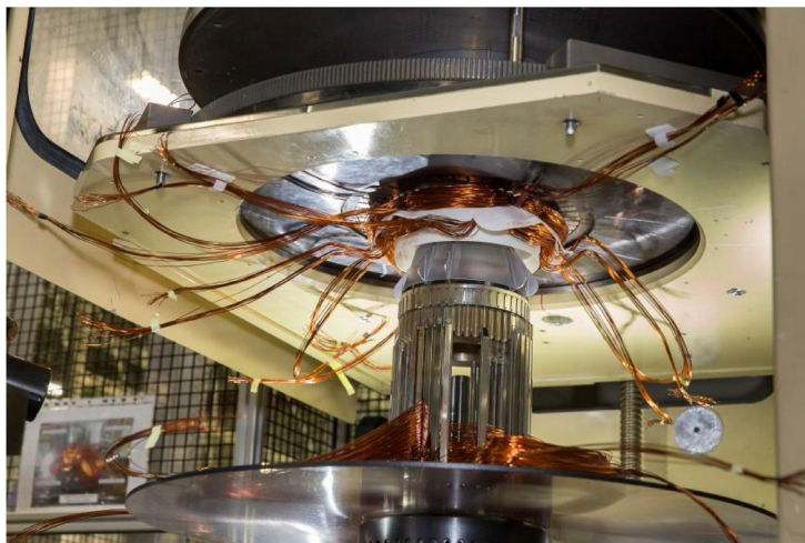
Rys. 1.17. Automatyczna produkcja uzwojeń stojana [21]
