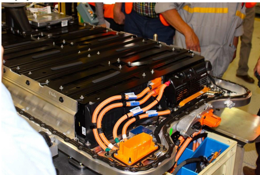
Rys. 1.38. Pakiet baterijny Renault Zoe [27]
