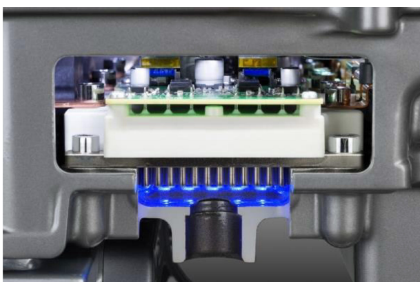
Rys. 2.15. Nissan Leaf II – płytka elektroniczna falownika [33]
