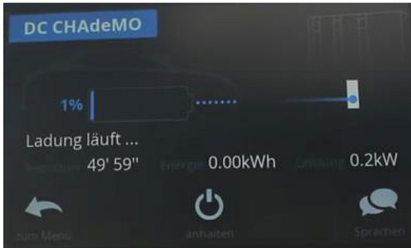
Rys. 2.41. Panel ładowarki Greenway (początek ładowania).
