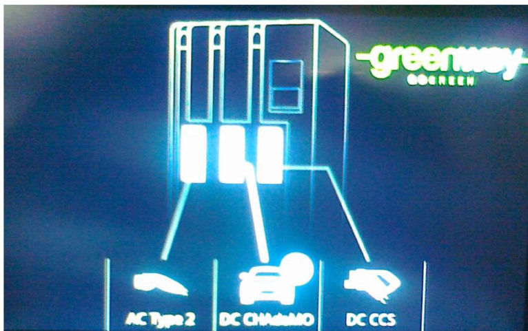
Rys. 2.39. Panel ładowarki Greenway (wybór trybu ładowania)
