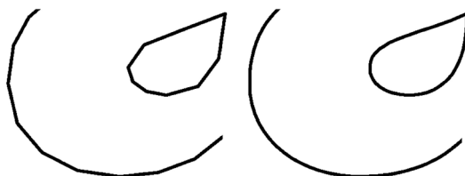
Rys. 1.8. Porównanie dokładności odwzorowania krzywych eksportowanych ze starszej (po lewej) i nowszej wersji (po prawej) programu CorelDRAW do formatu Autodesk
