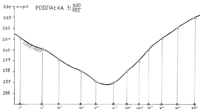
Rys. 6.2.5.12. Profil terenu w osi drogi wykonany na podstawie planu warstwicowego
