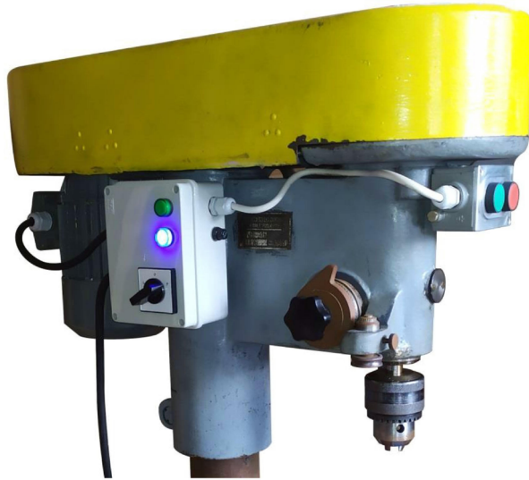
Rys. 3.3. Fotografia działającego urządzenia zamontowanego na wiertarce stołowej WS-15
