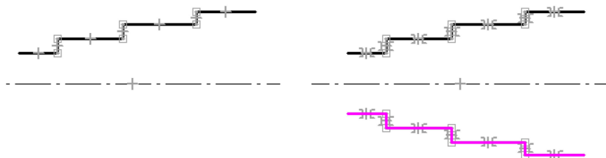
Rys. 4.11. Rysowanie głównych krawędzi zewnętrznych wałka oraz odbicie lustrzane względem osi symetrii – widoczne symbole relacji
