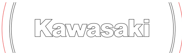
Rys. 1.9. Obraz wektorowy zaimportowany w programie Solid Edge do środowiska 'Szkic (ISO metryczne)'
