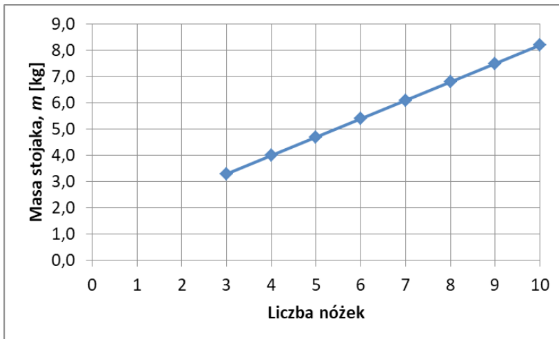
Rys. CS. 4 Wykres całkowitej masy stojaka w zależności od liczby nóg
