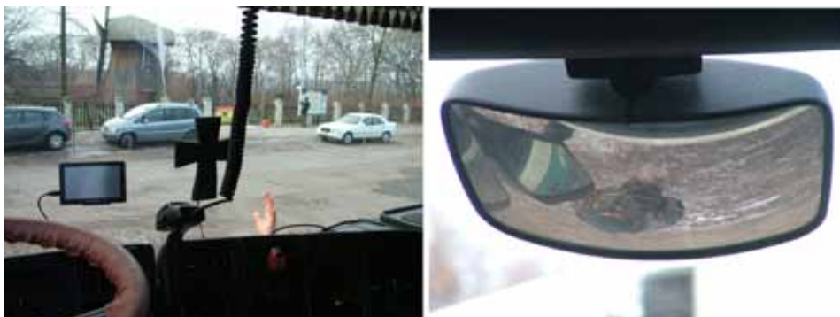
Rys. 5. Widoczność pozoranta z pozycji oczu kierowcy oraz jego obecność w lusterku bocznym
