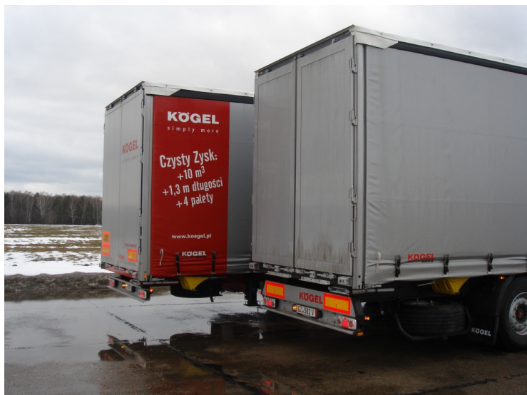
Fot. 4. Naczepa o normatywnej długości i naczepa badana, wydłużona o 1,3 m
