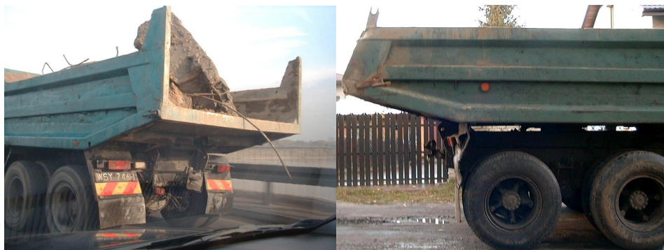
Fot. 2. Przykłady niebezpiecznego wystawiania skrzyń ładunkowych samochodów samowyładowczych
