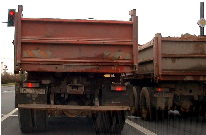
Fot. 3. Przykład samochodów samowyładowczych tej samej marki i typu – z belką przeciw najazdową oraz bez niej
