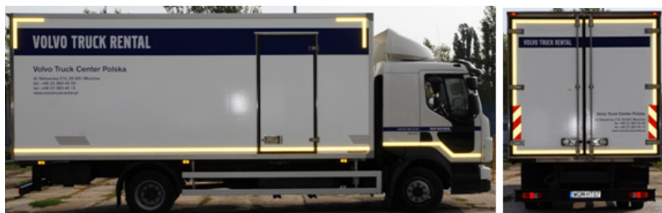
Fot. 4. Oznakowanie odblaskowe konturowe samochodu ze ścianami sztywnymi – grafika nieodblaskowa
