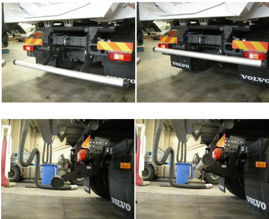
Fot. 5. Przykład zastosowania tylnej belki przeciw najazdowej przestawianej na czas wyładunku
