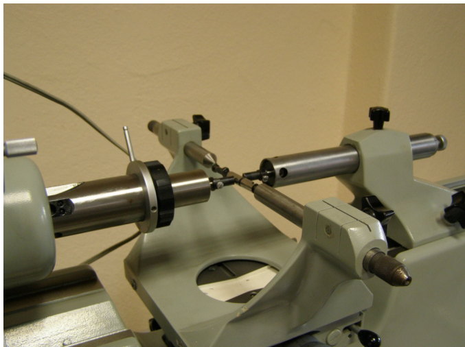
Rys. 2.6. Pomiary średnic elementu tłoczącego na części prowadzącej na długościomierzu poziomym firmy Carl-Zeiss Jena
