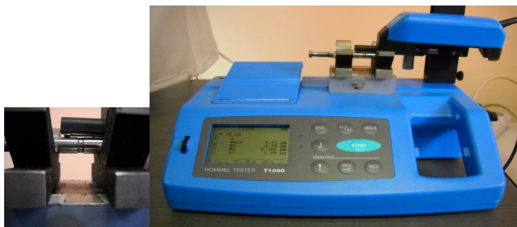
Rys. 2.10. Stanowisko do pomiaru chropowatości powierzchni elementu tłoczącego (przyrząd Hommel Tester T1000)
