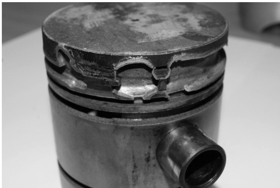
Rys. 4. Wyłamane progi pierścieni tłokowych
