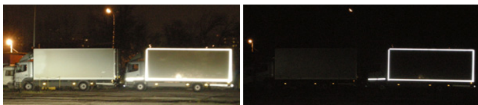
Fot. 9. Widoczność samochodów bez oznakowania konturowego i z oznakowaniem konturowym pełnym, w dobrym oświetleniu w otoczeniu pojazdów i w złym oświetleniu
