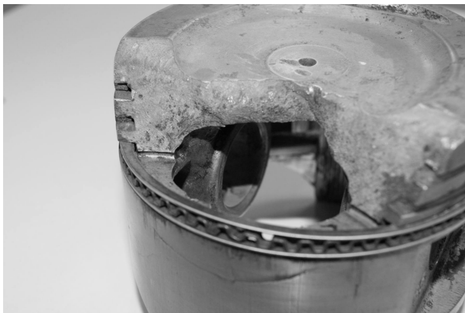
Rys. 2. Tłok silnikowy zniszczony przez „uderzenie cieczy”
