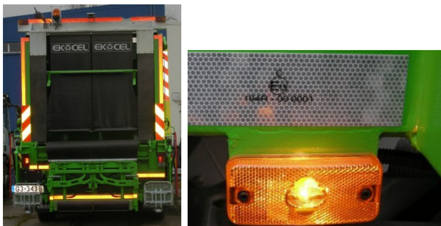
Fot. 2. Przykład oznakowania taśmą odblaskową wraz z innymi elementami odblaskowymi
