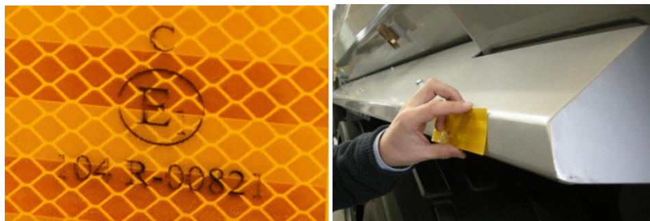
Fot. 3. Oznaczenie taśmy odblaskowej oraz widok miejsca na jej przyklejenie
