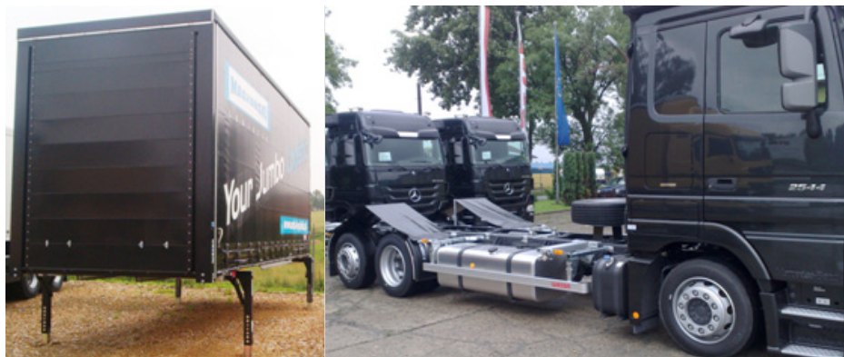
Fot. 6. Nadwozie wymienne nie podlegające obowiązkowi oznakowaniu oraz samochód do ich przewozu bez możliwości poprawnego oznakowania
