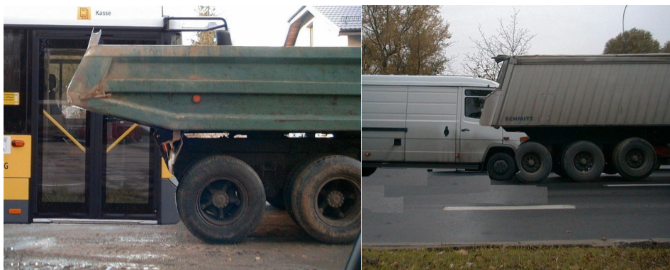
Fot. 4. Przykład symulacji skutków możliwego najechania autobusu lub samochodu dostawczego na wystającą nadmiernie skrzynię ładunkową pojazdu samowyładowczego
