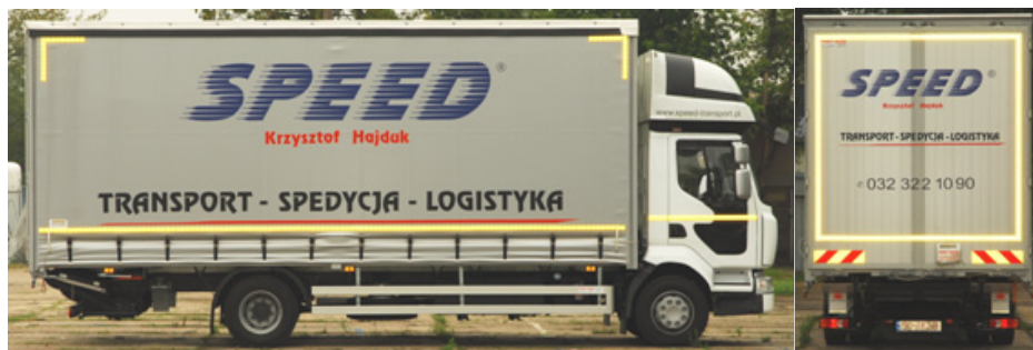
Fot. 5. Oznakowanie odblaskowe konturowe samochodu ze ścianą boczną kurtynową – grafika nieodblaskowa
