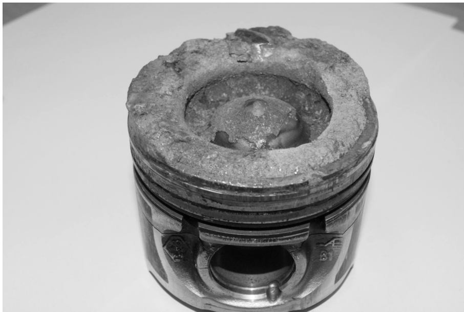
Rys. 3. Stopiona korona tłoka w silniku Diesla
