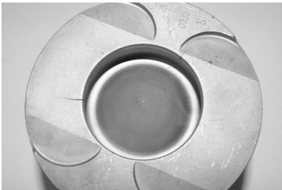
Rys. 1. Pęknięcia krawędzi komory spalania tłoka
