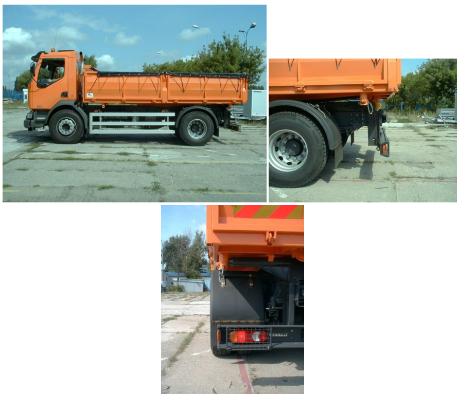
Fot. 1. Samochód samowyładowczy z tylnym urządzeniem zabezpieczającym
